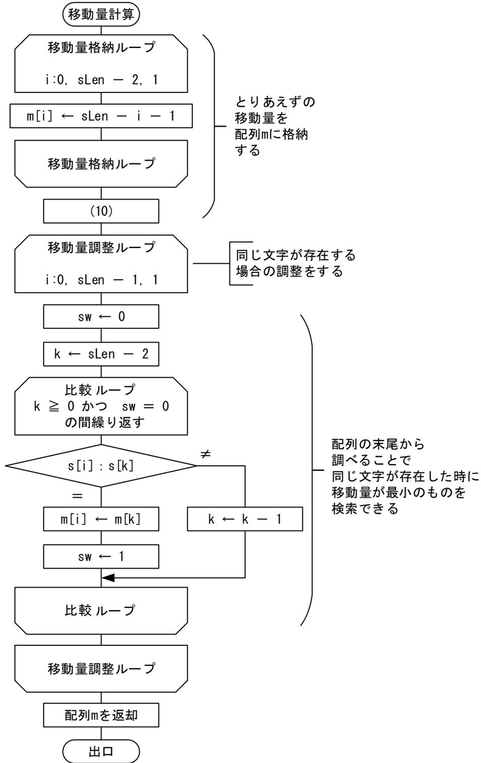
図 10 移動量計算の流れ図
